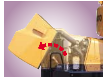
開閉が簡単なチルト式エンジンカバー
